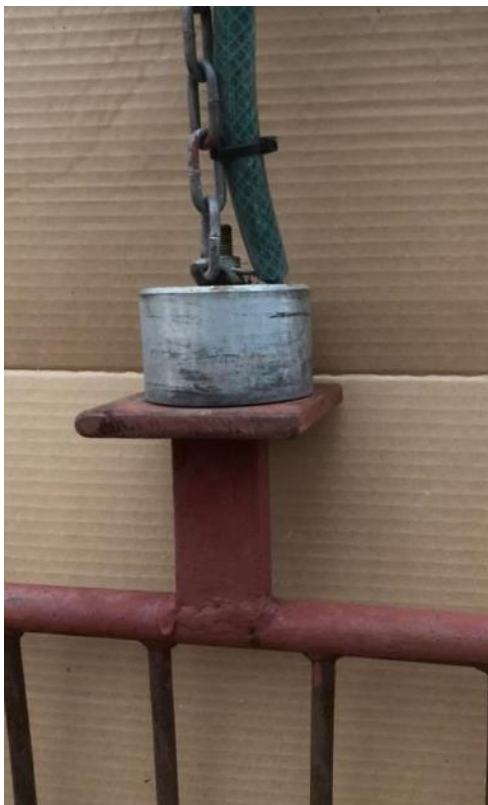
Abbildung 15: Magnet mit anhaftender Aufnahmeplatte und Falltor. Der Magnet hängt höhenverstellbar an einer Kette, die elektrische Leitung ist in dem Schlauch geschützt geführt (Foto: Dr. Jörg Melzheimer)
