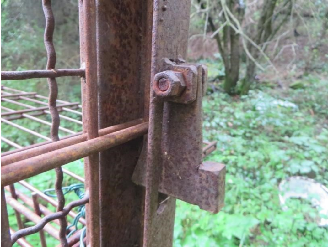
Abbildung 26: Durch die Montage einer Falltorsicherung wird beim Fang von stärkerem Schwarzwild das Ausheben der Falltür mit dem Gebrech unterbunden (Foto: Dr. Egbert Gleich)
