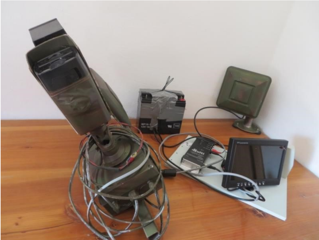
Abbildung 9: System zur Bildübertragung mittels lokaler Funkstrecke (Foto: Dr. Egbert Gleich)
