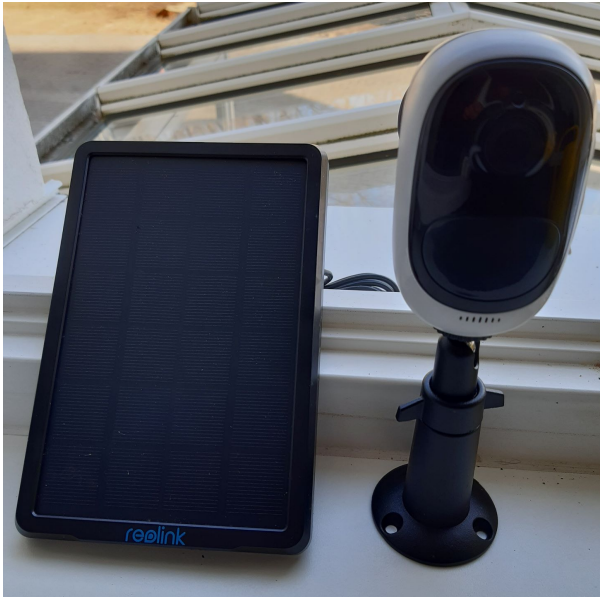
Abbildung 10: Exemplarische Abbildung einer 3G/4G- Kamera mit autarker Energieversorgung (Foto: Helmut Lehmann, Landesbetrieb Forst Brandenburg)
