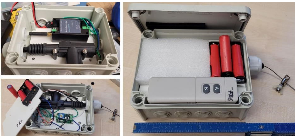
Abbildung 13: Stellmotorauslöser für mechanisches Fangschloss über GSM-Ansteuerung (oben links) sowie Version mit Auslösung per Kurzstreckenfunk (Foto: Staatsbetrieb Sachsenforst)
