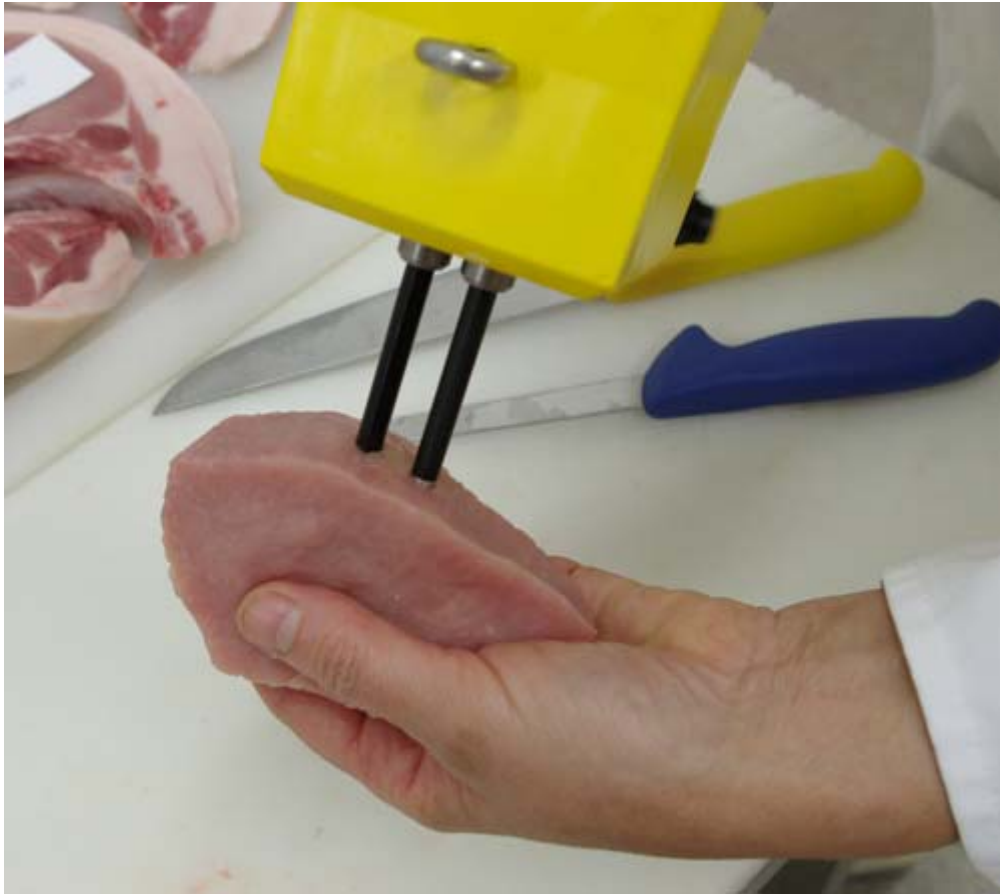
Abbildung 15: Leitfähigkeitsmessung direkt an der Probe
