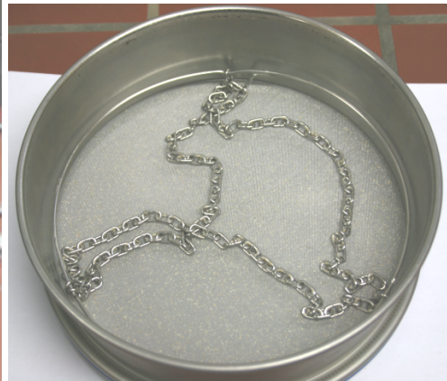
Abb. 1: Siebturm AS 200 control, Retsch GmbH (Foto: Döhne); Siebhilfe Kettenring (Foto: Pfeiffer)
