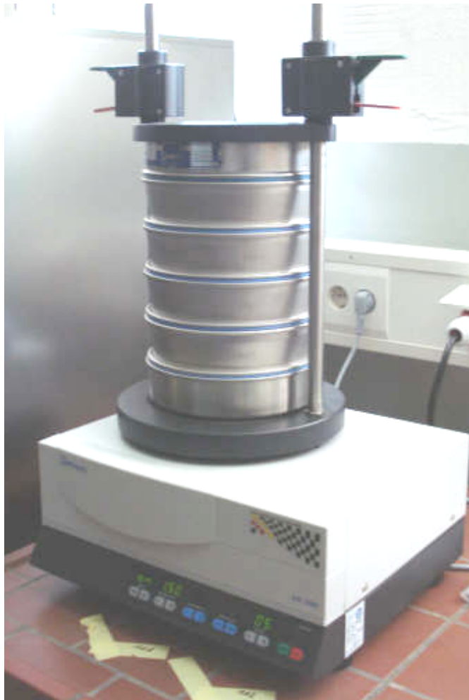
Abb. 1: Siebturm AS 200 control, Retsch GmbH (Foto: Döhne); Siebhilfe Kettenring (Foto: Pfeiffer)
