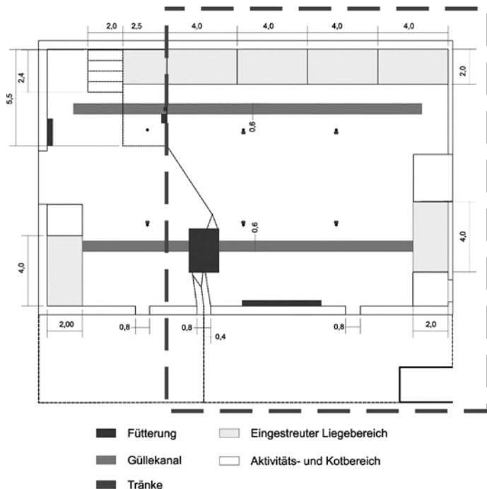
Abb. 1: Wartebereich der tragenden Sauen (umrandeter Bereich) Waiting area for pregnant sows (framed area)
